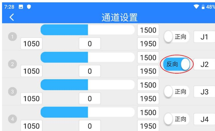
选中目标通道，点击对应的舵机正反向开关即可成功设置舵机正向和反向。
