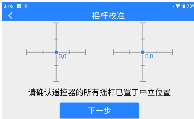
3. 按照提示，若双摇杆已经自然静止但摇杆通道输出值不为 0，说明摇杆中立点已经出现偏移。此时不要触碰摇杆，直接点击“下一步”。
