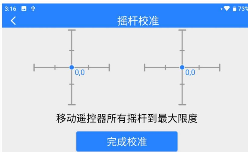
4. 中立点校准已完成，接下来校准最大限位。
