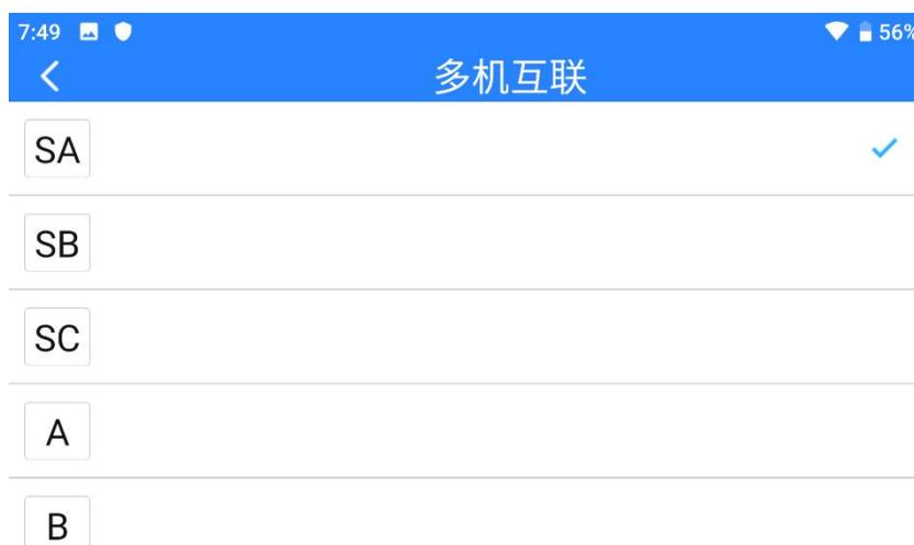
4. 在“通道设置”菜单下，按照实际需求分配好主机通道的映射关系，并分配所需要的通道给副机。这样，在“一机双控”功能激活时，主机可通过功能开关给予或收回副机对于已分配通道的控制权。
