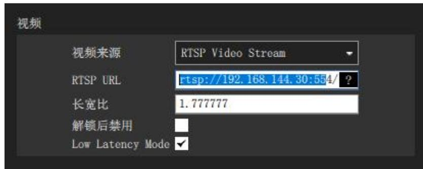
6. 在“RTSP URL”栏输入与天空端连接的相机设备的 RTSP 地址，即可显示对应相机的图像。
