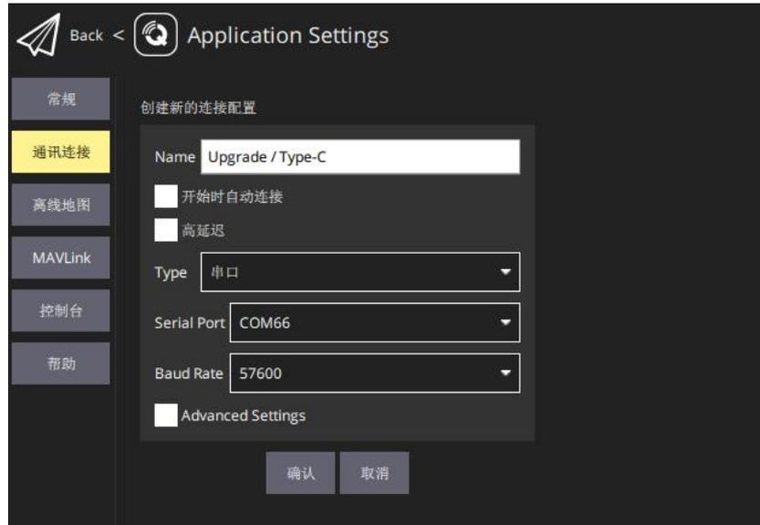
4. 将连接类型“Type”选为“Serial”，选择对应端口及波特率。
