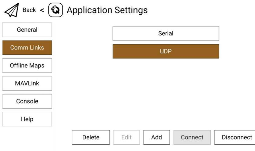
4. 选择设置好的 “UDP” 连接方式并点击 “Connect”，QGC 地面站顶部进度条有变化即说明遥控器与地面站的数传通信已经进入自动连接的过程，连接完成后即可正常通信。
