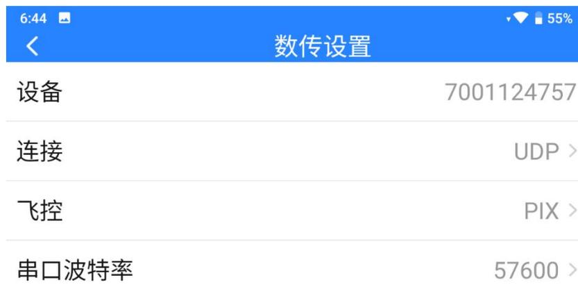
2. 运行 Mission Planner 地面站软件，选择对应端口（UDPC1）及波特率，接口“Port”设置为“19856”，服务器地址“Server Addresses”输入“192.168.144.12”，最后点击连接即可。
