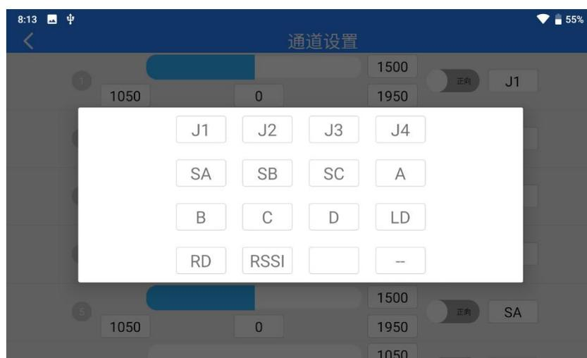
选中目标通道，点击通道映射按钮，弹出开关列表，选择所需要的开关，即可成功连接。
