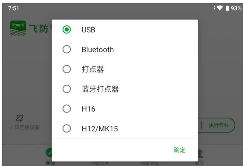
3. 点击“确定”后，遥控器将与飞控地面站自动连接，并提示“设备已连接”，表示数传可以正常通讯。
