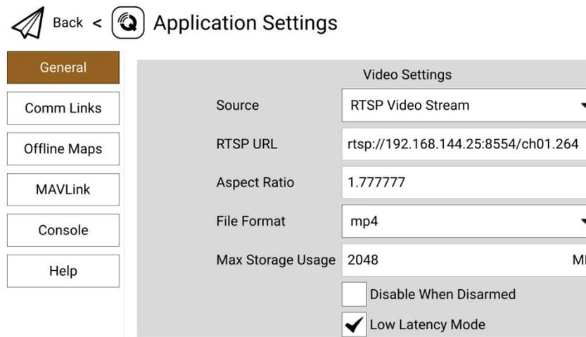
3. 将视频源（Source）选择为“RTSP Video Stream”，接着在下面的“RTSP URL”一栏粘贴已经复制好的网口相机或吊舱的 RTSP 地址。
