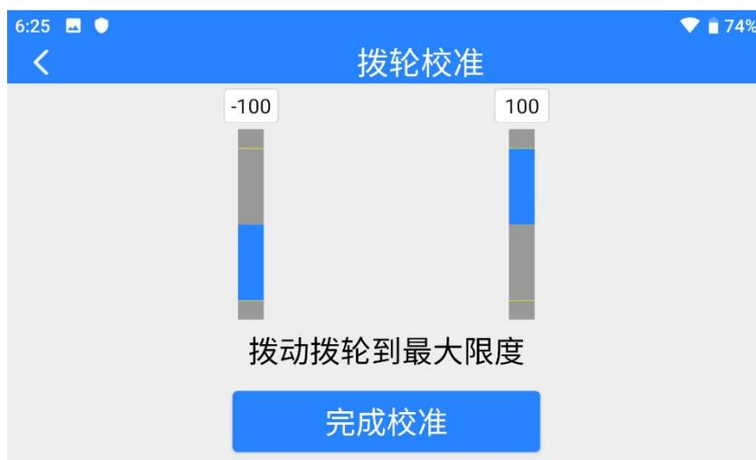
按照界面提示，将每个拨轮依次推到各个方向的最大限位。
